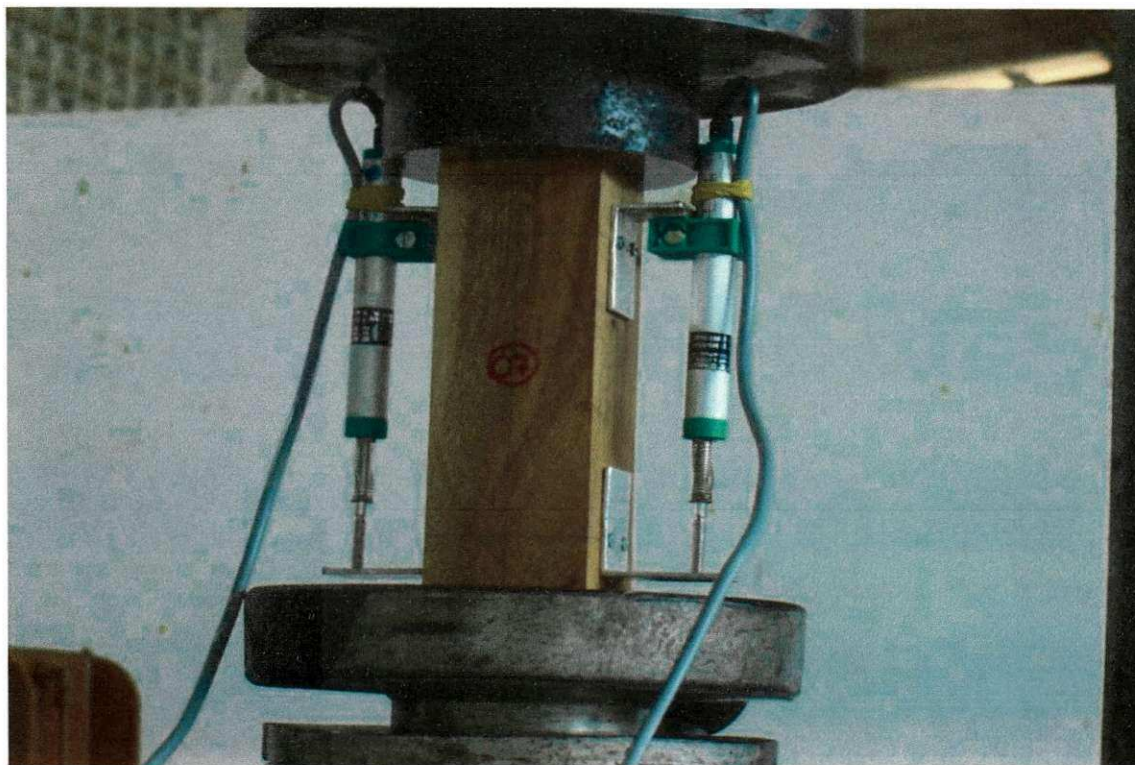
Figura 16. Corpo-de-prova alinhado entre os pratos da máquina de ensaios mecânicos.
