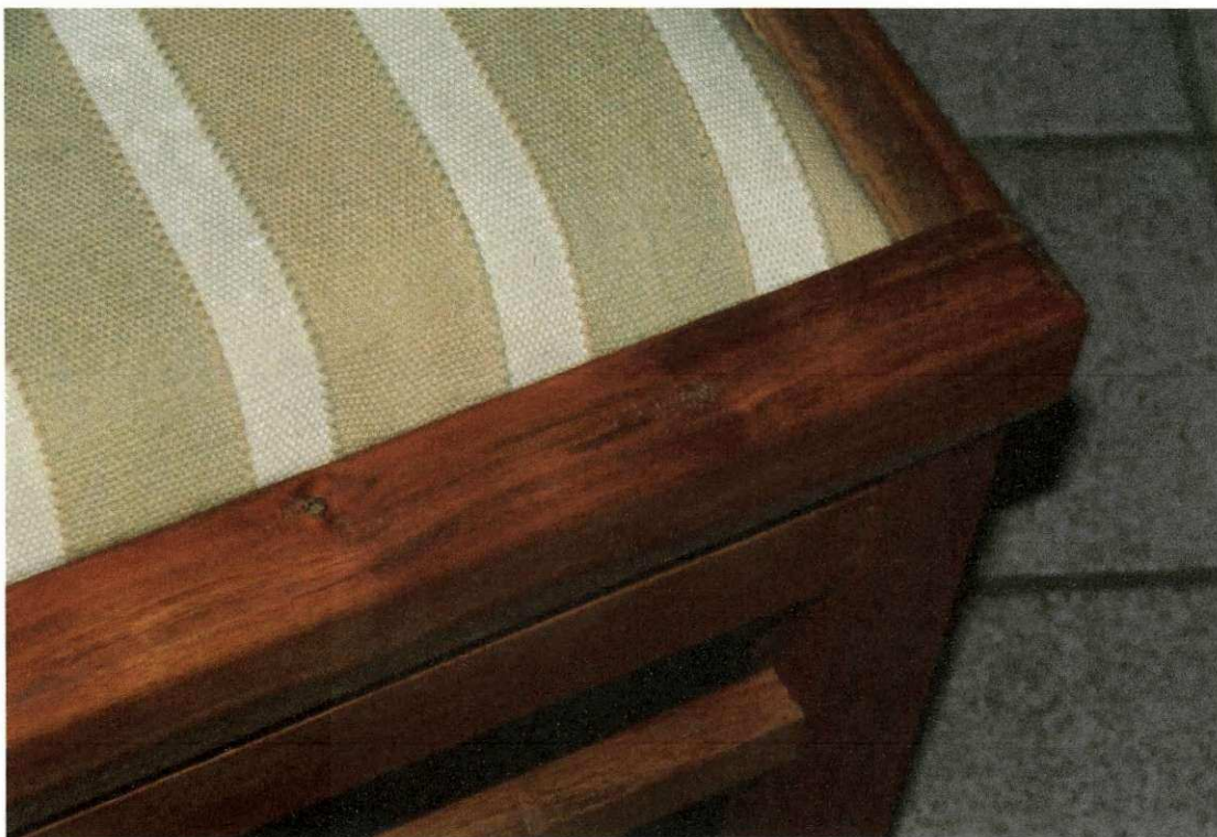
Figura 21. Madeira apresentando defeitos que impossibilitaram o seu uso para confecção dos corpos-de-prova.
