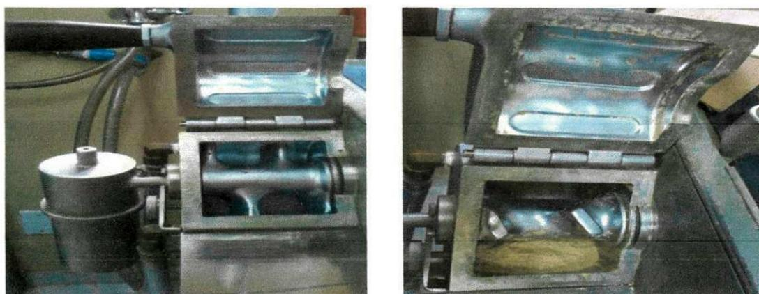
A PCL e seus concentrados foram processados em uma extrusora dupla rosca corrotacional da Coperion (Werner-Pfleiderer ZSK 18), pertencente ao Laboratório de Processamento de Polímeros da UFCG, em condições de processamento descritas na Tabela 3. Os concentrados de polímero/argila foram incorporados na PCL, em teor nominal de 3% em peso de argila, sob as mesmas condições de processo utilizadas para o polímero puro. Na Figura 24 está ilustrado o perfil da rosca utilizado na extrusão dos materiais.
