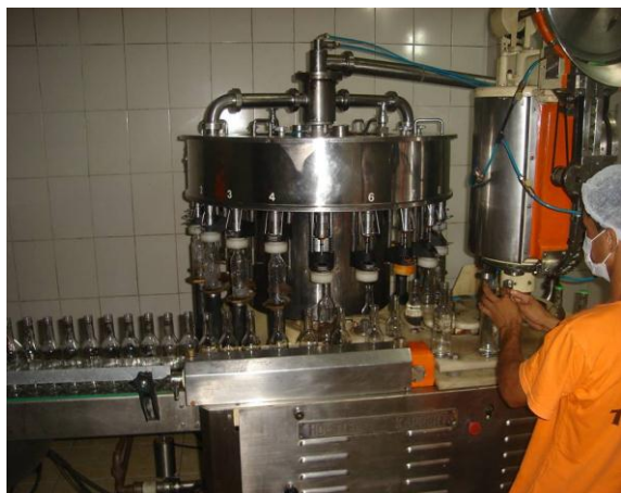
Foto 12 – Máquina para engarrafamento, lacre, rotulagem e selagem da cachaça FONTE – Acervo proprietário (2014)
