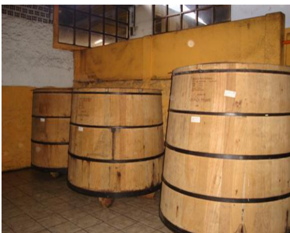
Foto 11 – Toneis para armazenamento e envelhecimento da cachaça FONTE – Acervo proprietário (2014)
