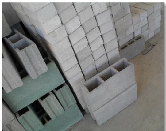
08. Pré-moldados produzidos a partir da brita do quartzito, resíduo gerado na etapa de britagem/moagem dos rejeitos das serrarias
