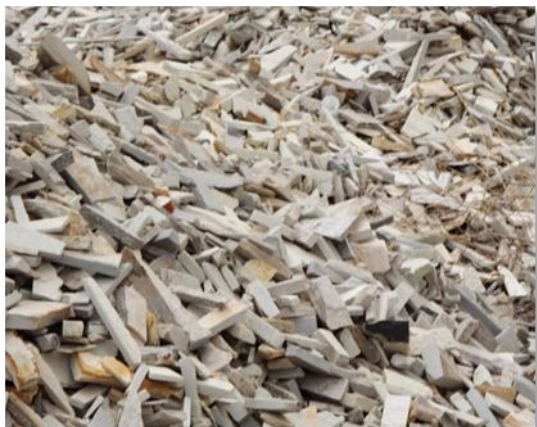
01. Resíduo gerado através das atividades de beneficiamento do quartzito das serrarias
