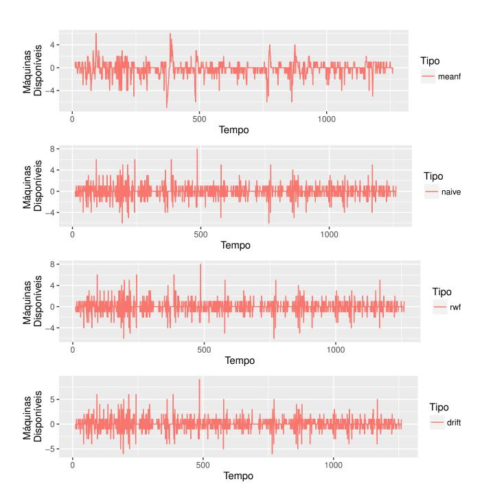
Figura B.3: Erros de predição por preditor para a máquina com ID 97959424 do *cluster* do Google com 1 janela de predição de 15 minutos no futuro.
