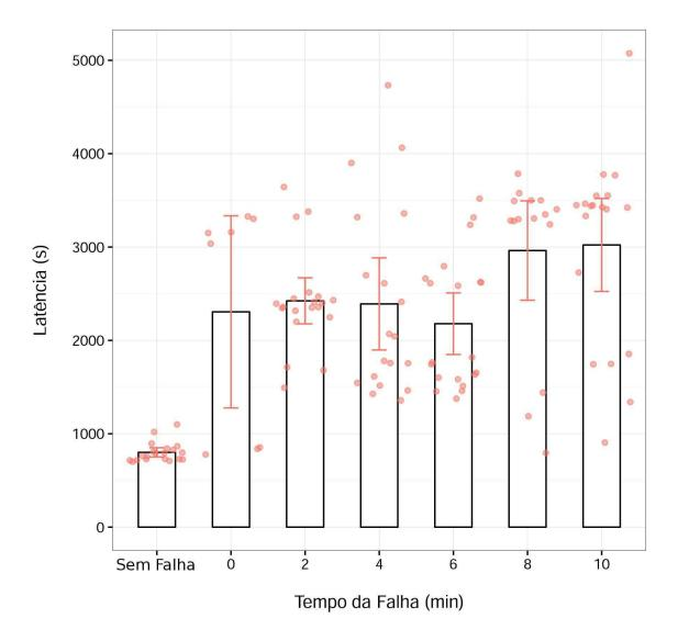
Figura 4.7: Tempo médio de completude de tarefas Hadoop na presença de falha em diferentes pontos da execução, incluindo a fase *Map* e *Reduce*.
