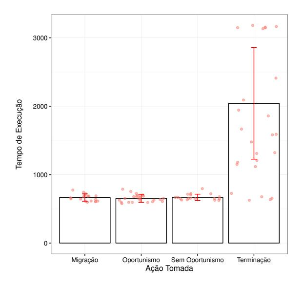
Figura 4.14: Tempo média de completude de uma tarefa Hadoop do tipo *Terasort* utilizando oportunismo nos cenários onde há falha e a instância é terminada, há falha e a instância é migrada, quando não há interferências e também sem oportunismo.
