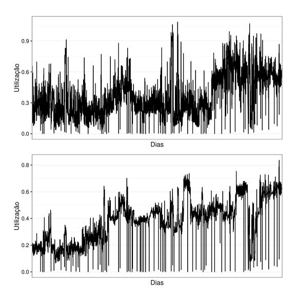
Figura C.4: Gráfico de utilização de CPU e memória RAM, dos 29 dias do registro do Google para máquina com ID 4302737021.
