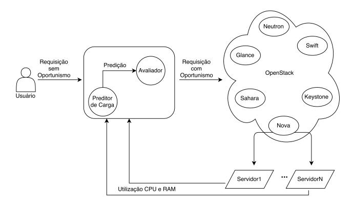
Figura 3.1: Arquitetura da solução proposta. Um novo componente é inserido entre o usuário e o Sahara e é responsável por avaliação do estado da nuvem para criação de *clusters* Hadoop utilizando oportunismo ou não.
