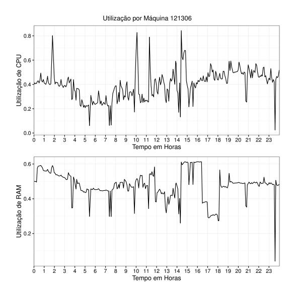
Figura C.2: Gráfico de utilização de CPU e memória RAM por hora, do primeiro dia do registro do Google para máquina com ID 121306.
