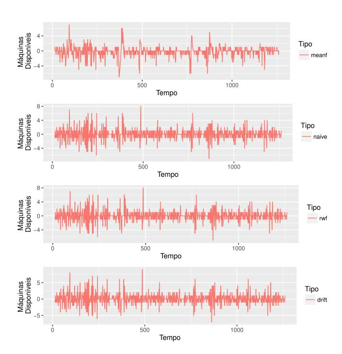
Figura B.4: Erros de predição por preditor para a máquina com ID 97959424 do *cluster* do Google com 2 janelas de predição de 15 minutos no futuro.
