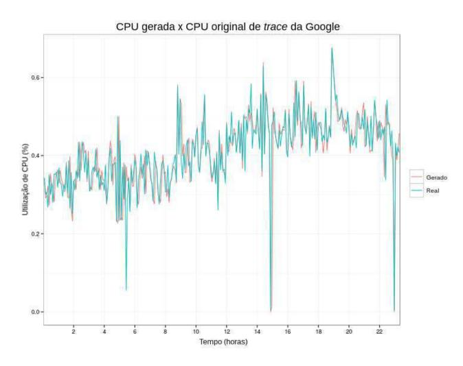
Figura 4.1: Comparação entre sintética e carga real, baseada em dados de *data center* do Google.
