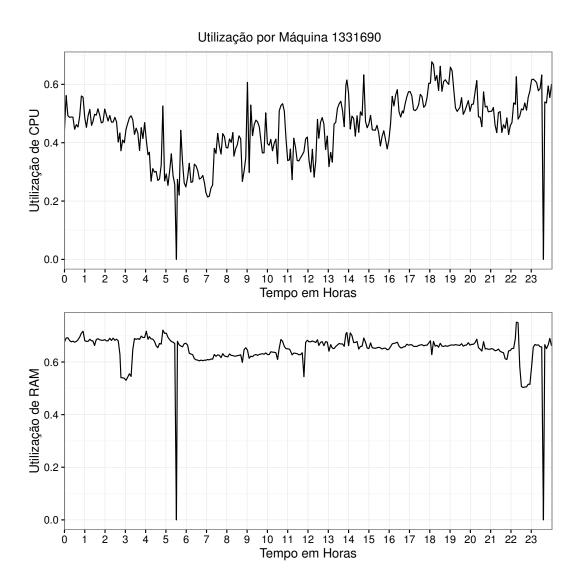
Figura 1.3: Gráfico de utilização de CPU e memória RAM por hora, do primeiro dia do registro do Google para máquina com ID 1331690.
