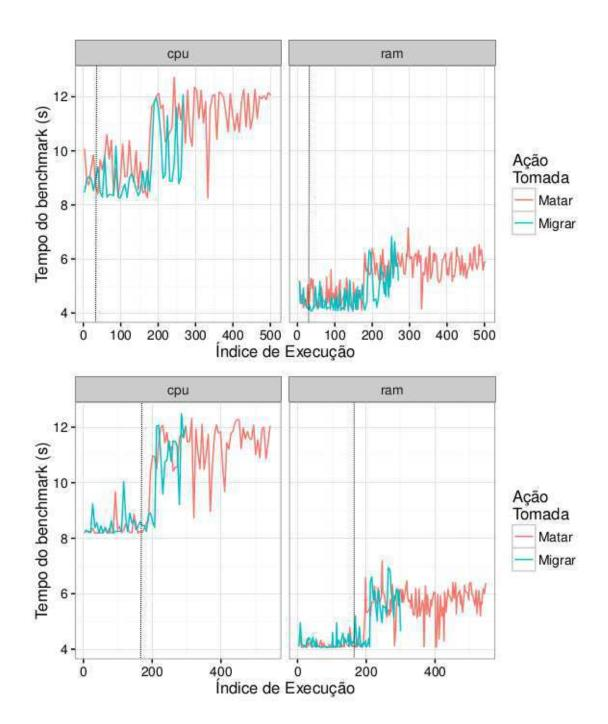
Figura 4.13: Tempo médio do *benchmark* de CPU e memória RAM medidos em máquinas virtuais em cada nó da nuvem, ao longo do tempo considerando o momento do pico de carga. Nos gráficos da parte superior da figura o pico ocorre na fase *Map*, enquanto nos gráficos da parte inferior da figura o pico ocorre na fase *Reduce*.
