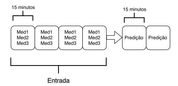
Figura 3.2: Exemplo do janelamento utilizado na predição de recursos disponíveis. Onde Med1, Med2 e Med3 representam as três medições, em intervalos de 5 minutos, utilizadas na criação da janela utilizada pelo preditor. O maior valor individual de utilização de CPU e de memória RAM entre esses 3 é selecionado para ser considerado na predição.
