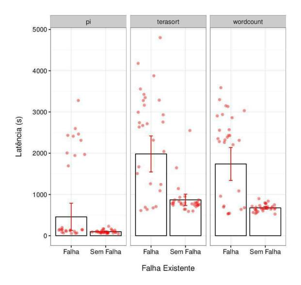
Figura 4.6: Tarefas Hadoop na presença de falha.
