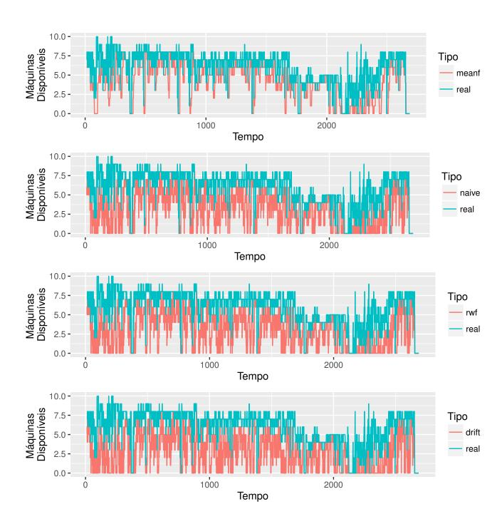
Figura B.6: Predição de recursos ociosos por preditor para máquina com ID 97959424 do *cluster* do Google com predição de 2 janela de 15 minutos no futuro, utilizando preditor pessimista.
