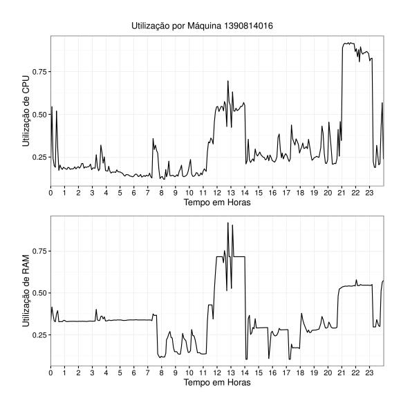
Figura C.1: Gráfico de utilização de CPU e memória RAM por hora, do primeiro dia do registro do Google para máquina com ID 1390814016.
