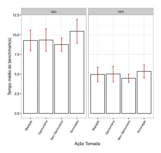
Figura 4.12: Tempo médio do *benchmark* de CPU e memória RAM medidos em máquinas virtuais em cada nó da nuvem, agrupados por ação tomada.
