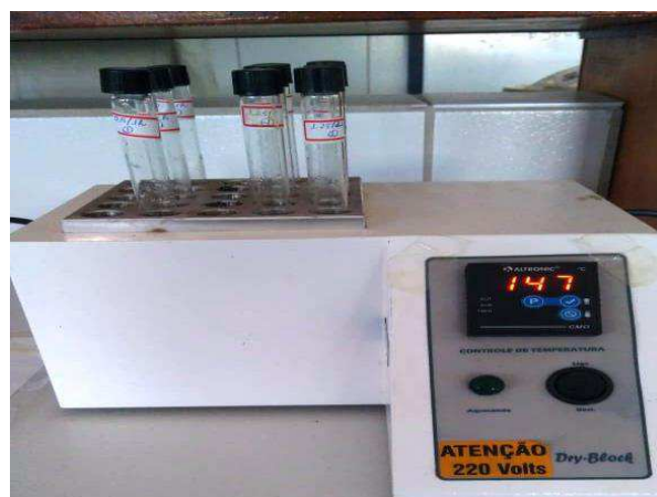
Figura 11 - Amostras em tratamento no bloco digestor
