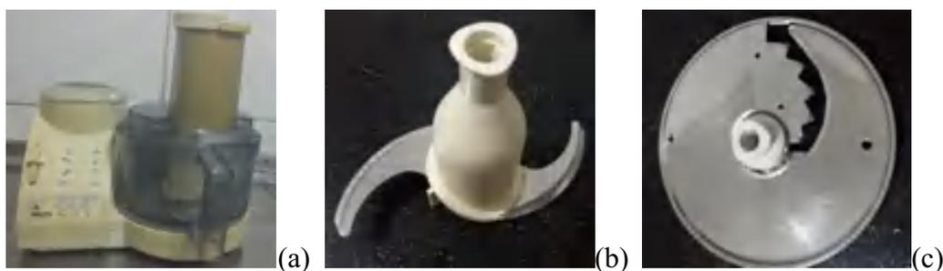
**Figura 3.3.** Processador e lâminas utilizados para triturar as amostras
