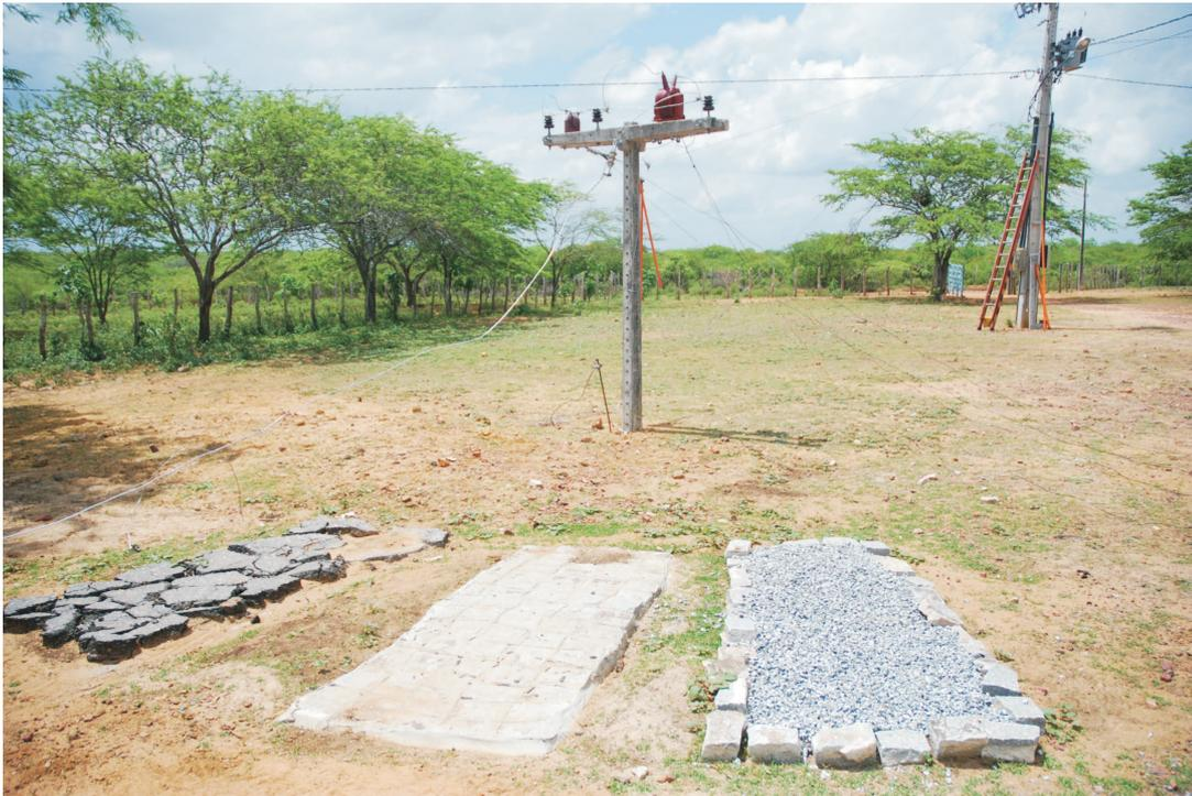
**Figura 3.1.** Estrutura montada em uma fazenda na cidade de Boa Vista - PB composta por diferentes superfícies de contato e um poste onde foram instalados TC e TP.
