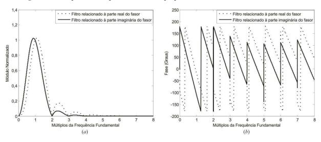
Figura 4. 9 – Resposta em frequência do método proposto combinado com o filtro Butterworth.
