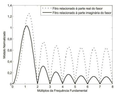
Figura 2. 6 – Módulo da resposta em frequência da combinação dos filtros: Mímico e FDFT.
