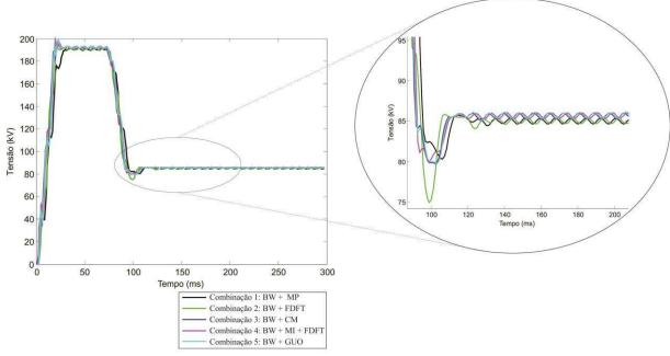
Figura 6. 12 – Amplitude do fasor corrente da fase A estimada pelos métodos avaliados, considerando os transformadores para instrumentos reais.
