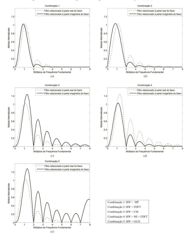
Figura 6. 3 – Módulo das respostas em frequência das Combinações 1, 2, 3, 4 e 5.
