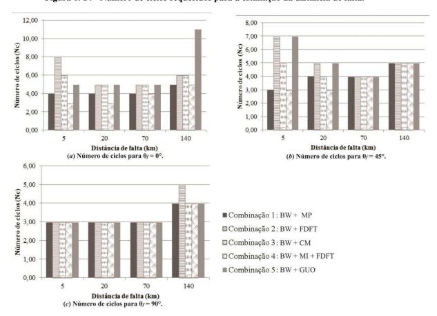
Figura 6. 14 - Número de ciclos requeridos para a estimação da distância de falta.
