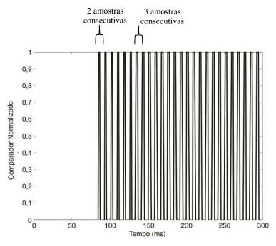
Figura 6. 27 – Tripping time para faltas bifásicas AB com  $R_f = 5 \Omega$ .
