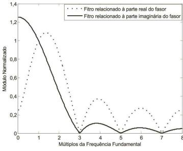
Figura 2. 3 – Módulo da resposta em frequência dos filtros de Fourier de meio ciclo.
