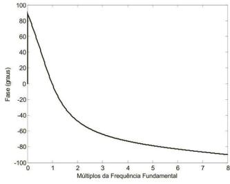
Com uma banda de passagem de 90,69 Hz não é possível obter um ganho igual a zero para as componentes harmônicas do sinal a ser filtrado. Por isso, para obter este efeito é necessário associar outros subfiltros. Logo, no método proposto, o subfiltro  $H_{bp}(z)$  é associado a outros subfiltros para filtrar componentes harmônicas, conforme descrito a seguir.
