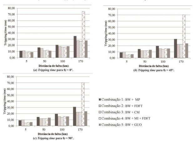
Figura 6. 25 – Tripping time para faltas monofásicas AT com  $R_f = 10 \Omega$ .
