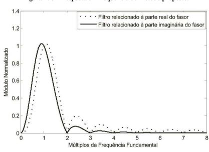
Figura 4. 8 – Resposta em frequência do método proposto.
