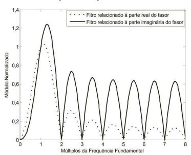
Figura 2. 4 – Módulo da resposta em frequência do método Cosseno Modificado.
