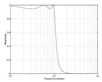
Figura 3. 4 – Módulo da resposta em frequência de um filtro de Chebychev.
