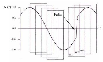
Figura 2. 1 – Janela móvel de amostras.
