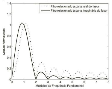
Figura 2. 2 – Módulo da resposta em frequência do Método FDFT.
