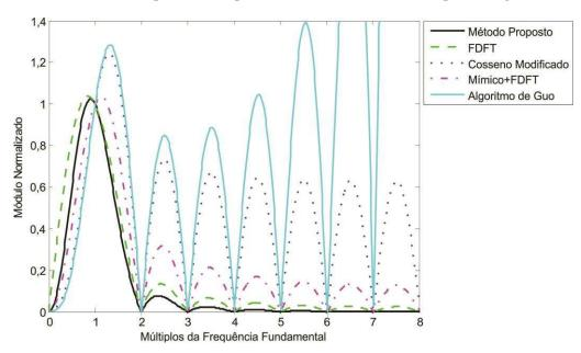
Figura 6. 2 – Módulo da resposta em frequência dos filtros relacionados à parte imaginária do fasor.
