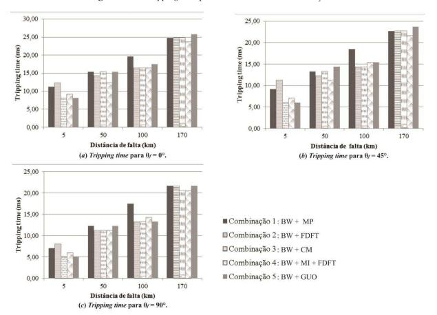
**Figura 6. 28** – *Tripping time* para faltas trifásicas ABC com  $R_f = 1 \Omega$ .
