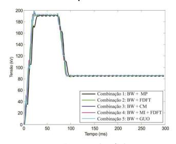
Figura 6. 9- Amplitude do fasor corrente da fase A estimada pelos métodos avaliados, considerando os transformadores para instrumentos ideais.
