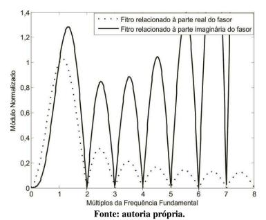
Figura 2. 5 – Módulo da resposta em frequência do algoritmo de Guo.
