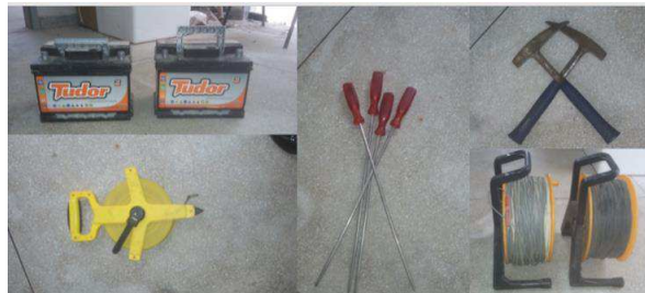
Figura 7.7. Materiais utilizados em campo: Baterias, trena, eletrodos, carreteis com fios, martelo de geólogo.
