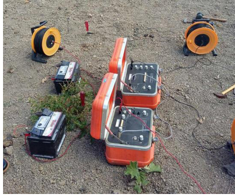
Figura 7.6. Equipamento utilizado para o levantamento de eletroresistividade.
