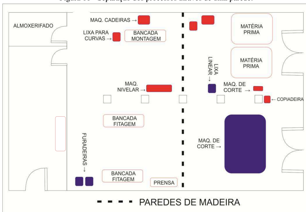
Figura 10 - Separação dos processos através de uma parede.
