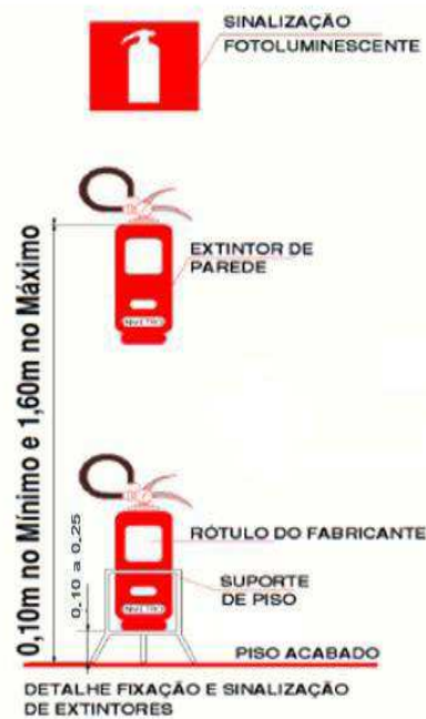
Figura 10 - Posição de instalação de extintores
