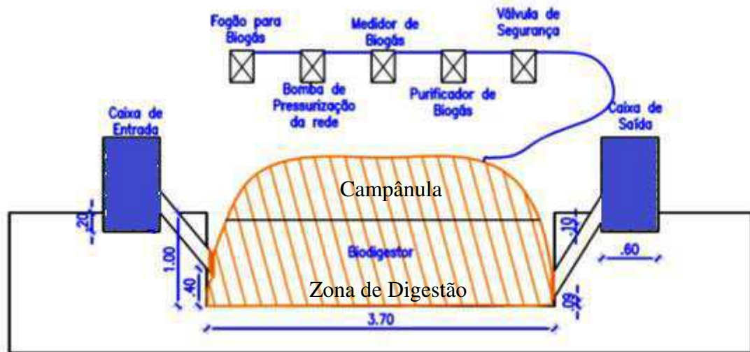
Figura 6 - Croqui do Biodigestor Canadense.
