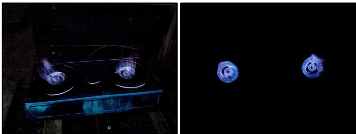
Figura 18 - Detalhe da cor da Chama produzida através da queima do biogás.
