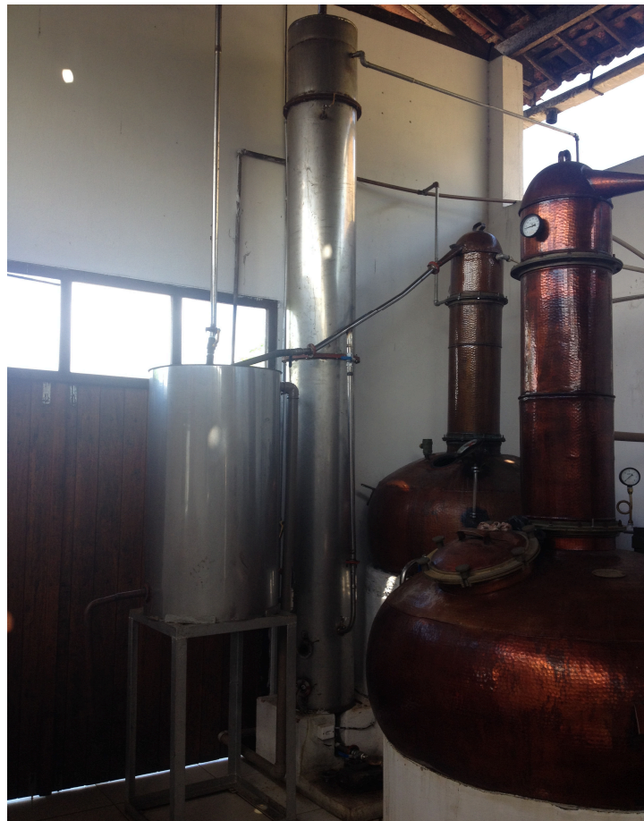
Coluna para transformação da cachaça de “cabeça” e “cauda” em álcool combustível
