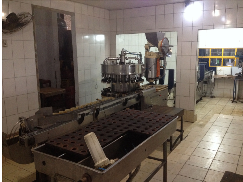
Máquinas de engarraamento (Etapa de engarraamento)
