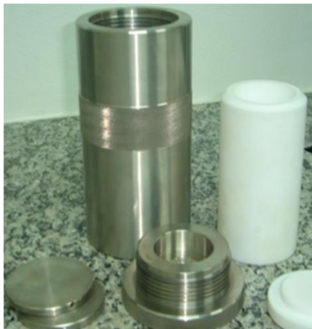
Figura 12. Autoclave utilizada na síntese da SBA-15.
