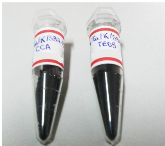
Figura 19. Catalisadores Fe/Cu/K/SBA-15TEOS e Fe/Cu/K/SBA-15CCA pós-síntese de Fischer-Tropsch.
