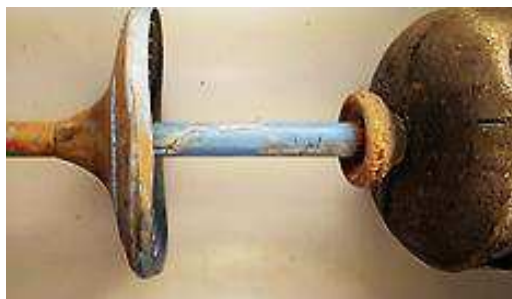
Figura 2.8 - Processo de erosão em isolador polimérico.
