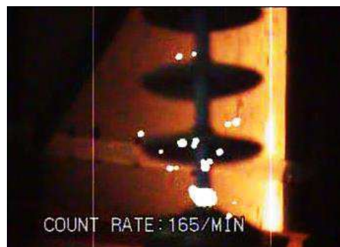
Figura 2.13 - Imagem de um isolador captada por uma câmera UV.
