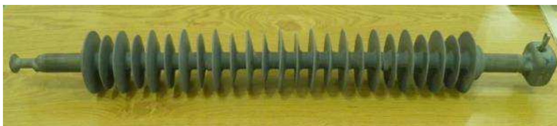
Figura 2.2 - Isolador Polimérico 69 kV.
