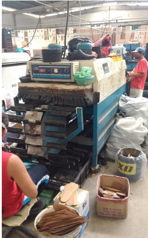
Foto 8 - Aquecimento da Cola no Solado e Cabedal na Máquina Secador e Reativador Horizontal
