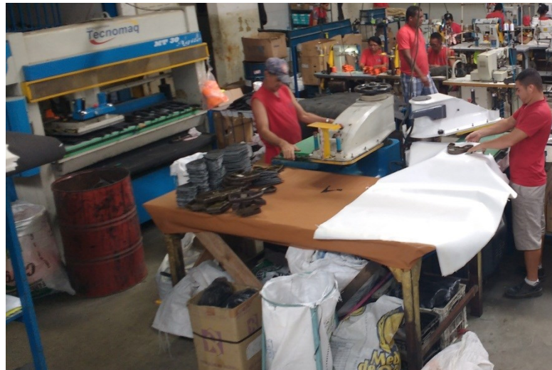
Foto 2 - Processo de Corte nas Máquinas “balançinho”
