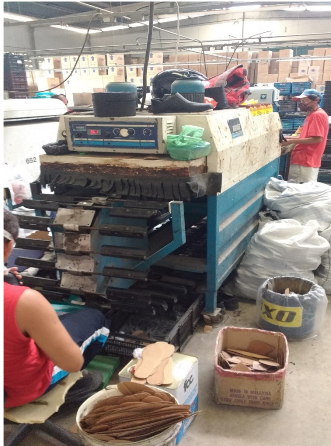
Foto 13 - Saída do produto na Máquina Secador e Reativador Horizontal.
