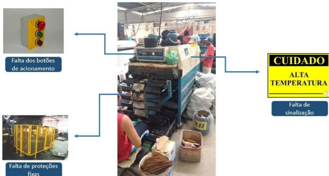
Figura 4 - Infográfico da máquina Secador e Reativador Horizontal
