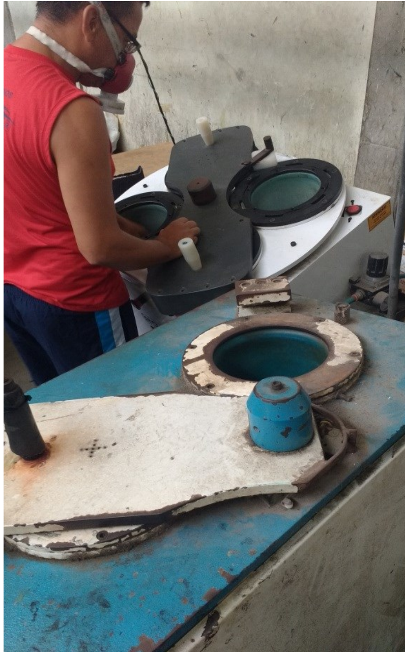
Foto 9 - Prensagem do Solado e Cabedal na Máquina de Prensagem
