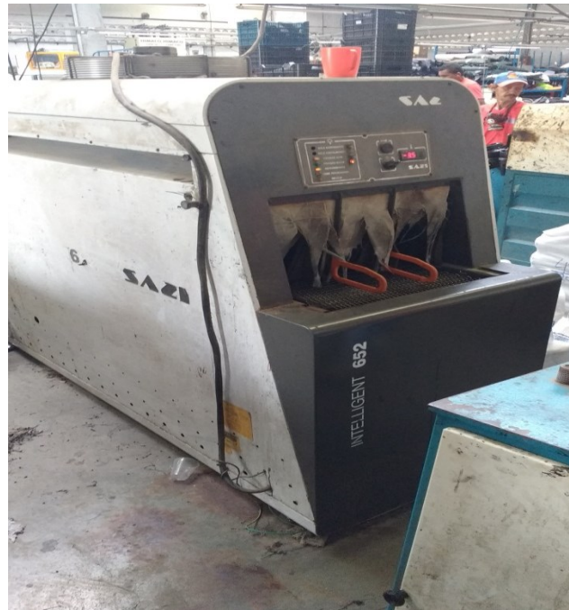
Foto 10 - Resfriamento do Calçado na Máquina de Resfriamento
