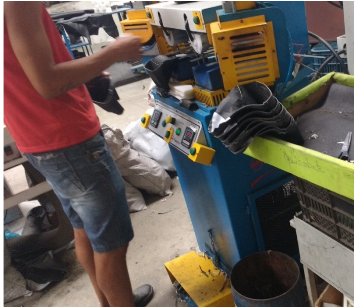
Foto 6 - Processo de Montagem dos Cabedais na Máquina de Conformação
