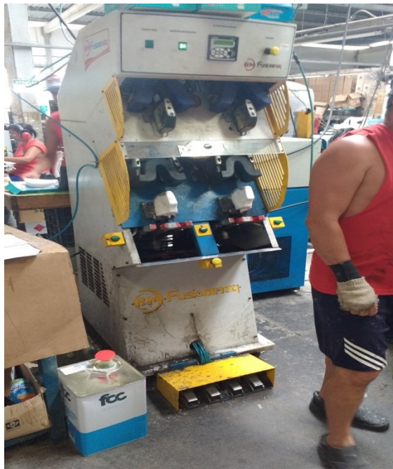
Foto 5 - Processo de Montagem dos Cabedais na Máquina de Conformar Contrafortes
