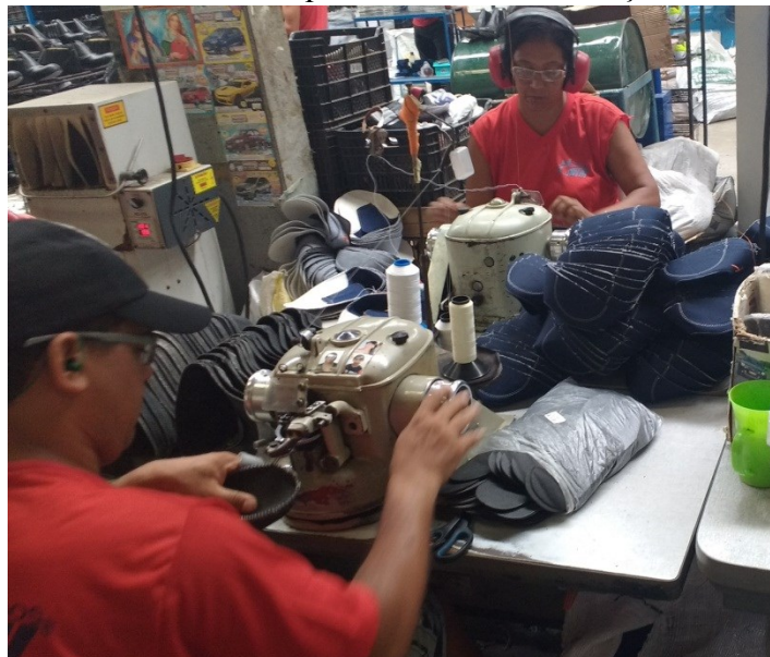
Foto 7 - Processo de Costura do Cabedal e a parte inferior da mesma na Máquina de Costura Reforçada
