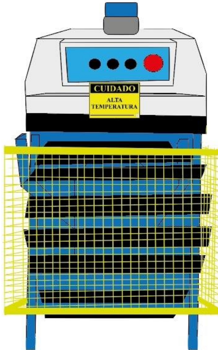
Figura 6 - Vista frontal da máquina com as sugestões de conformidades.
