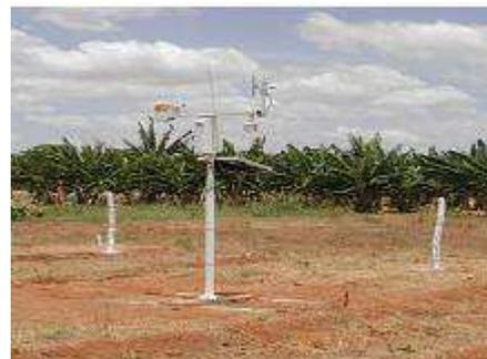
**Figura 4** – Instrumentos do experimento instalado na Fazenda Frutacor, Quixeré (CE): (a) anemômetro sônico 3D CSAT3; (b) saldo radiômetro CNR1; (c) analisador de H<sub>2</sub>O/CO<sub>2</sub> LI-7500; (d) sensor HPM45C; (e) torre micrometeorológica no interior do bananal e (f) estação automática ET106 (Fonte: Silva, 2009).
