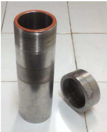
**Figura 3.3.** Reator tubular de aço inoxidável.
