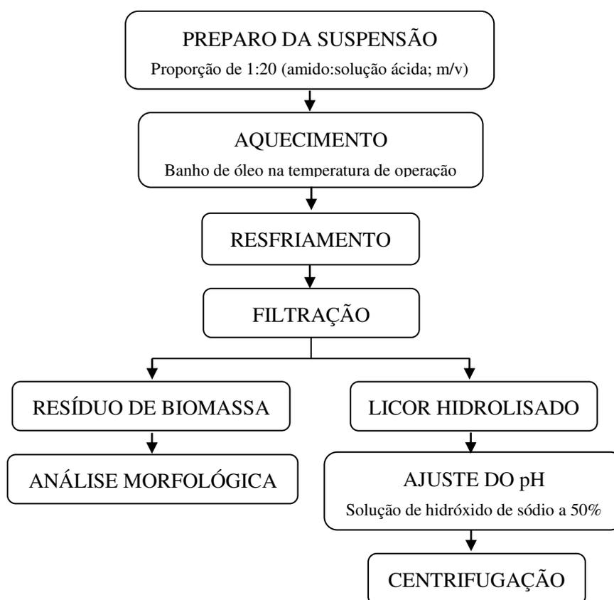
**Figura 3.5.** Fluxograma referente ao processo de hidrólise ácida do amido de sementes de executado nas condições otimizadas de operação.
