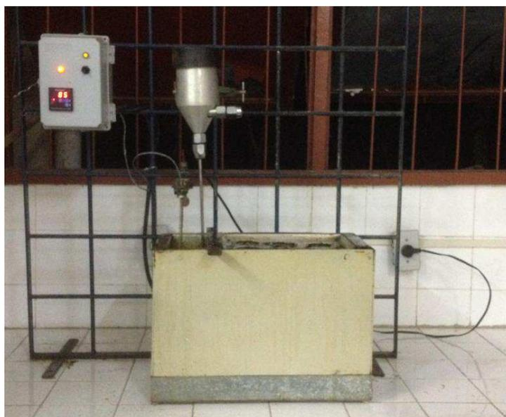
**Figura 3.4.** Banho de óleo com aquecimento controlado sob agitação.
