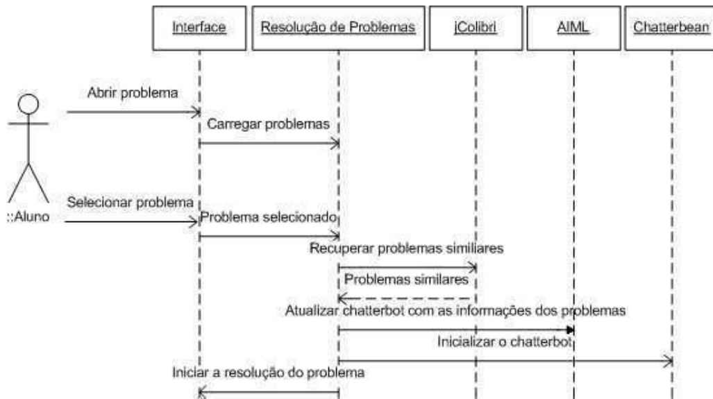
Figura 4.6: Diagrama de sequência da seleção do problema para resolução.
