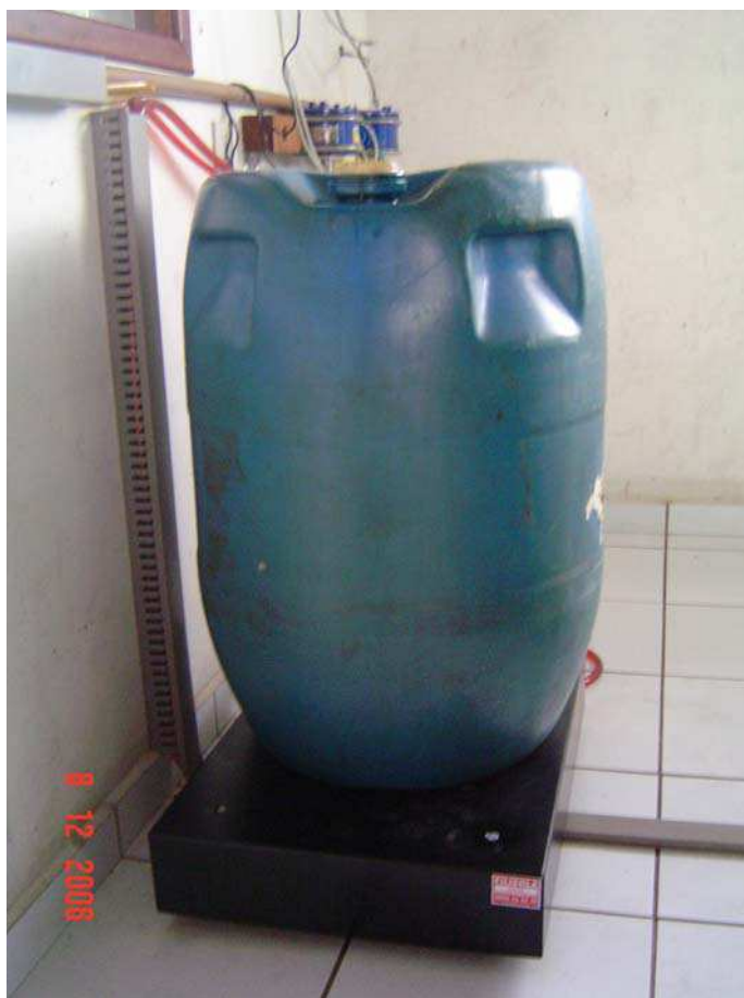
Figura 3.5a – Sistema de pesagem do combustível diesel.
