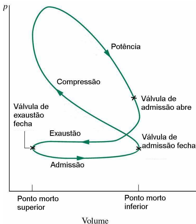
Figura 2.2 - Diagrama pressão-deslocamento para um motor de combustão interna alternativo. Fonte: Moran e Shapiro (2000)
