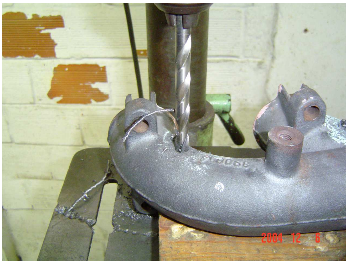
Figura 3.7 – Perfuração do coletor de escape para receber os termopares.
