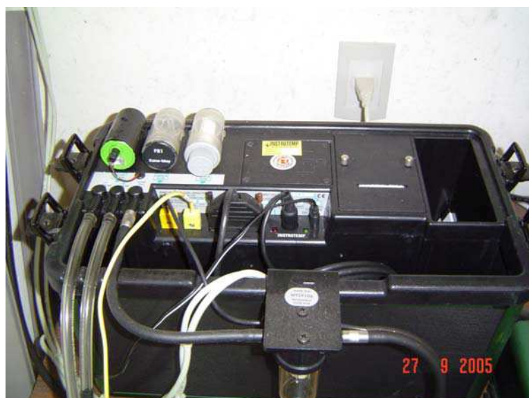
Figura 3.16 - Analisador de gases.
