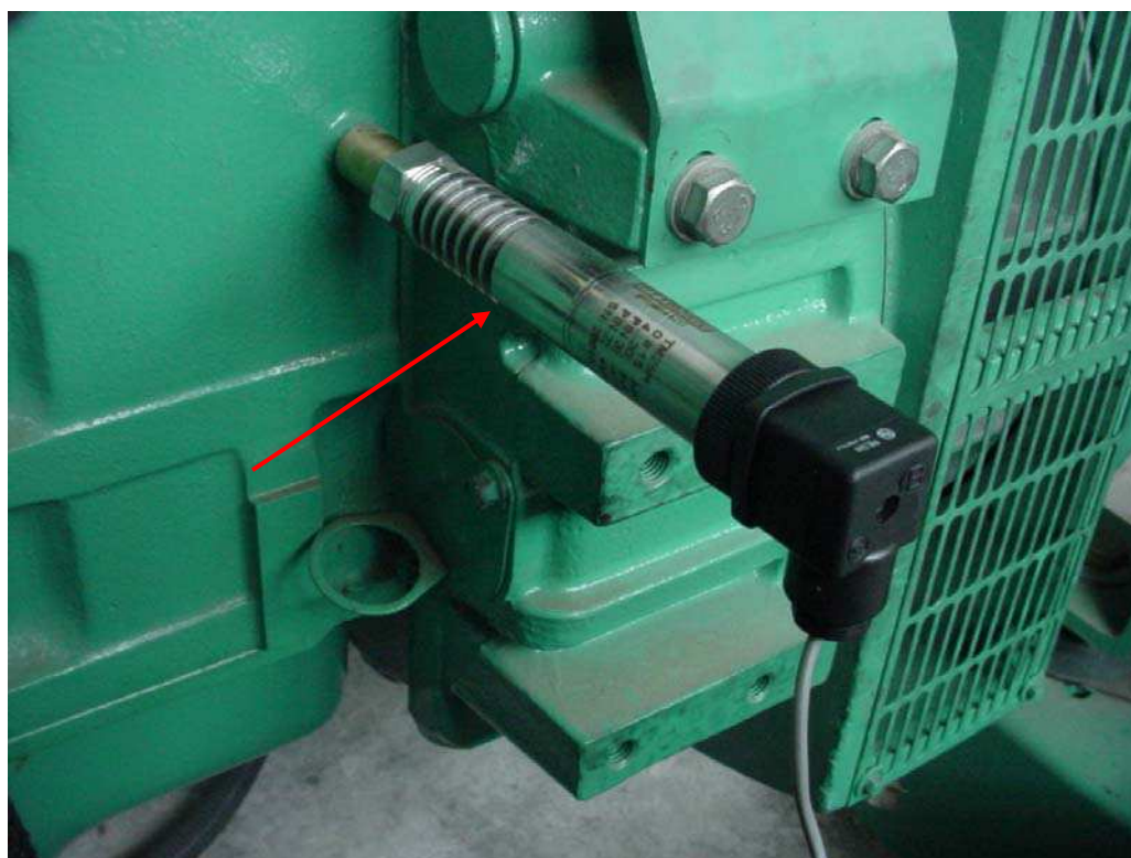
Figura 3.11 - Transdutor para medição da pressão do óleo lubrificante.
