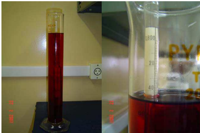
Figura 3.1 – Procedimento para medição da densidade do óleo diesel
