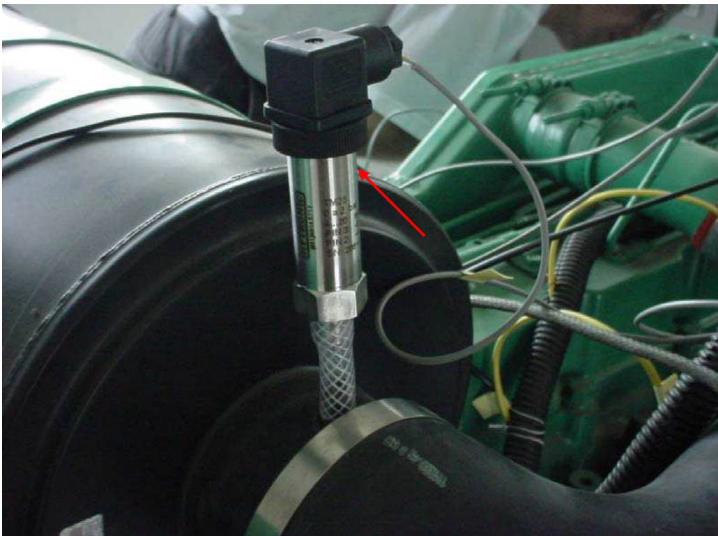
Figura 3.9 – Sensores de medição de pressão e temperatura do ar na entrada do motor.
