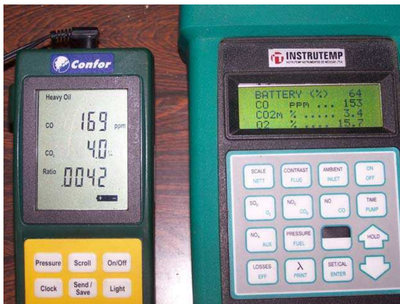
Figura 3.19 - Vista dos analisadores de gases.
