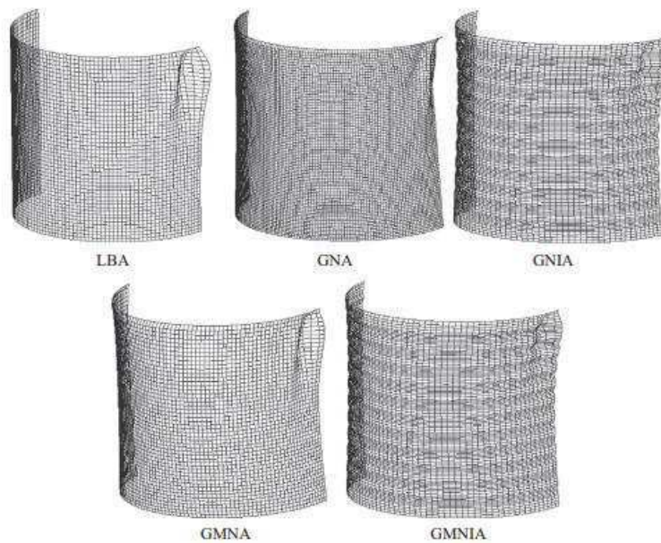
Figura 39 - Deformações no silo no caso WE.
