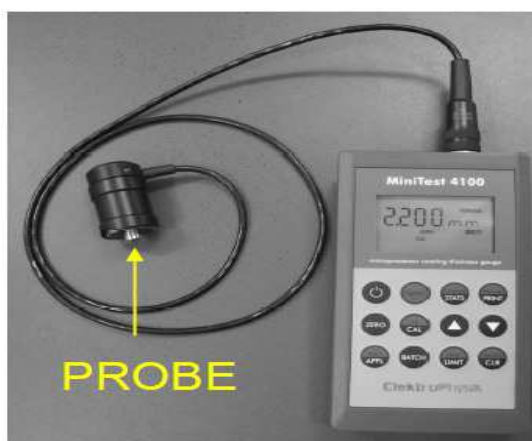
Figura 10 - Dispositivo utilizado para medição da espessura do diafragma
