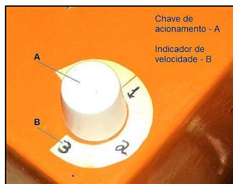
Figura 7 – Sistema de acionamento
