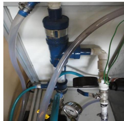
**D) Membrana de Microfiltração**
