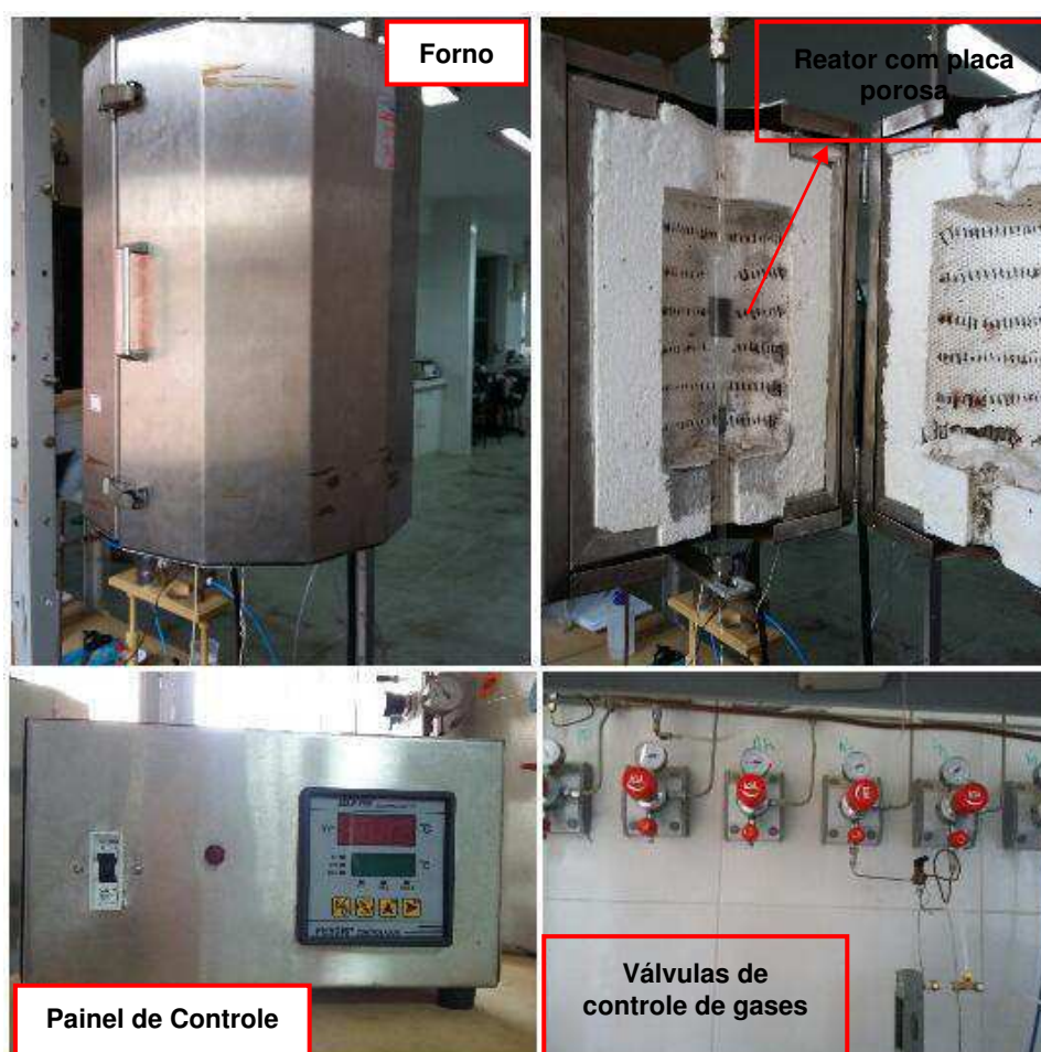
Figura 20 - Sistema utilizado para a calcinação dos catalisadores.
