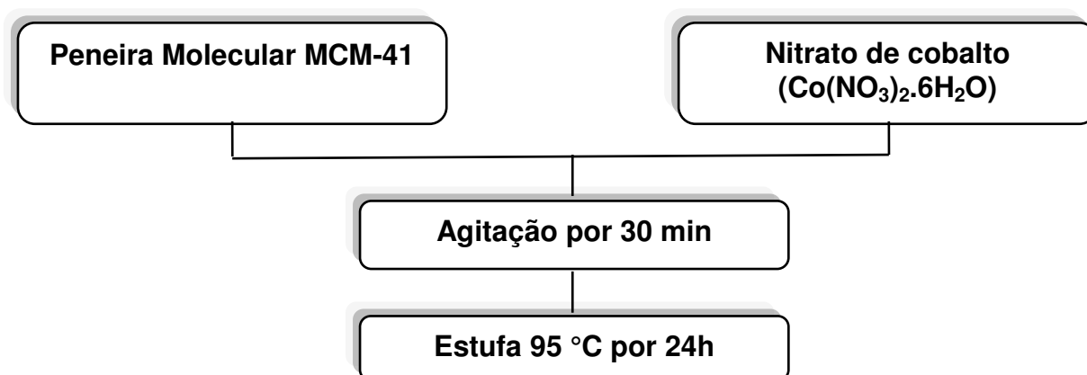
Figura 19 - Diagrama da incorporação do cobalto sobre a peneira molecular MCM-41(SA) e MCM-41(CCA).
