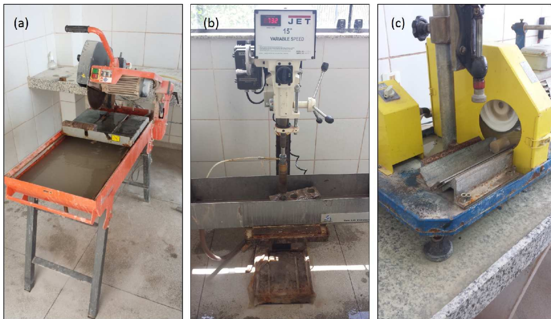
Figura 73 – Equipamentos utilizados, presentes na sala de preparação de amostras do LabPetro UFCG. (a) Serra de bancada, (b) plugadeira de bancada e (c) retificador.
