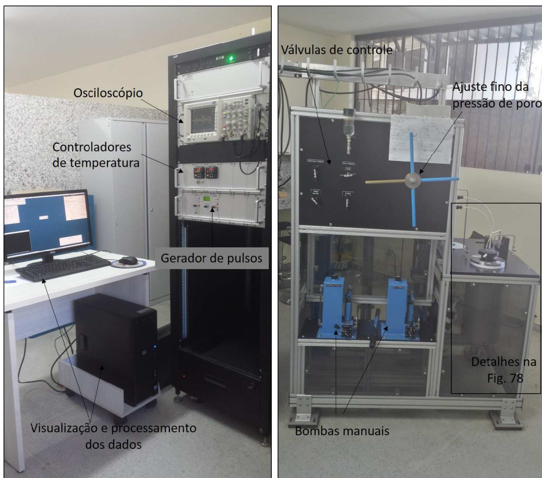
Figura 76 – Sistema Autolab500, presente no LabPetro UFCG.
