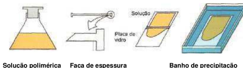
Figura 12: Esquema representativo da fabricação de uma membrana pela técnica de imersão-precipitação. Fonte: HABERT et al., 2006.
