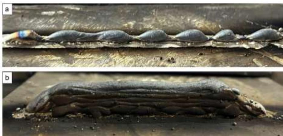
Figura 24: Efeito da transição do *Humping* da parede (Autoria própria)
