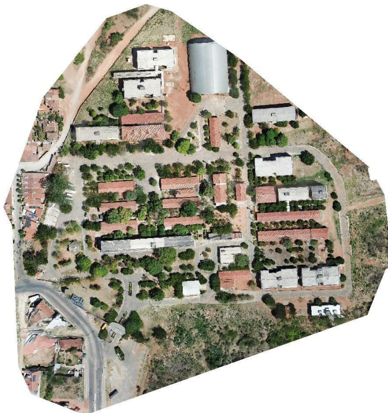
Figura 54: Mapa de projeção 2D gerada via Software a partir das imagens aéreas capturadas com o Drone.
