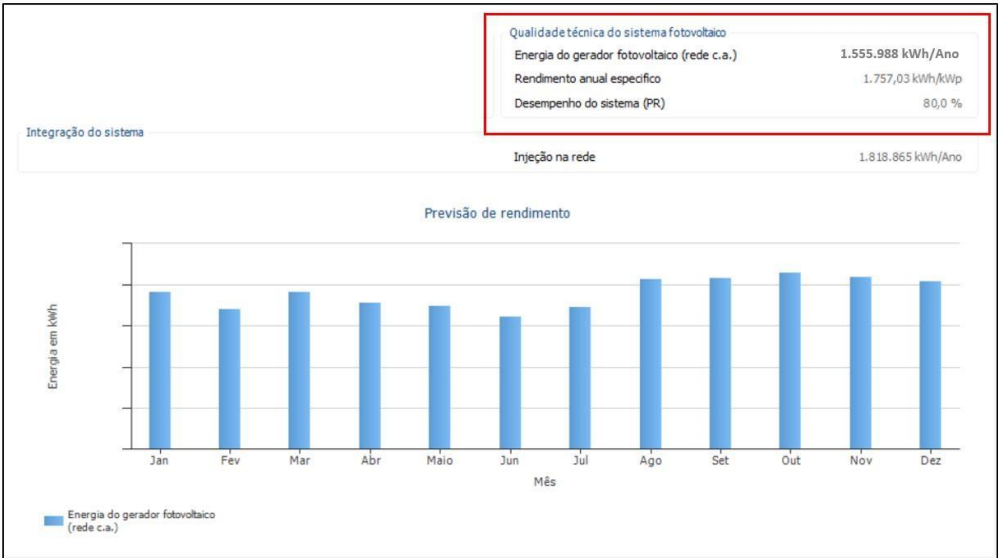
Figura 76: Estimativa mensal de geração de energia da usina fotovoltaica simulada no software PV*SOL.
