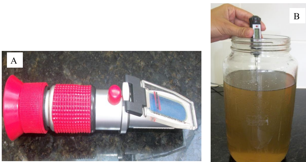
Figura 3.3 - Refratômetro portátil (A) e medição da temperatura da Solução (B)
