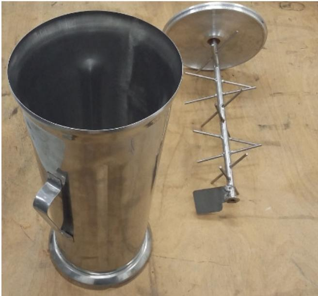
Figura 32. Câmara de amostra e haste e tampa mancal
