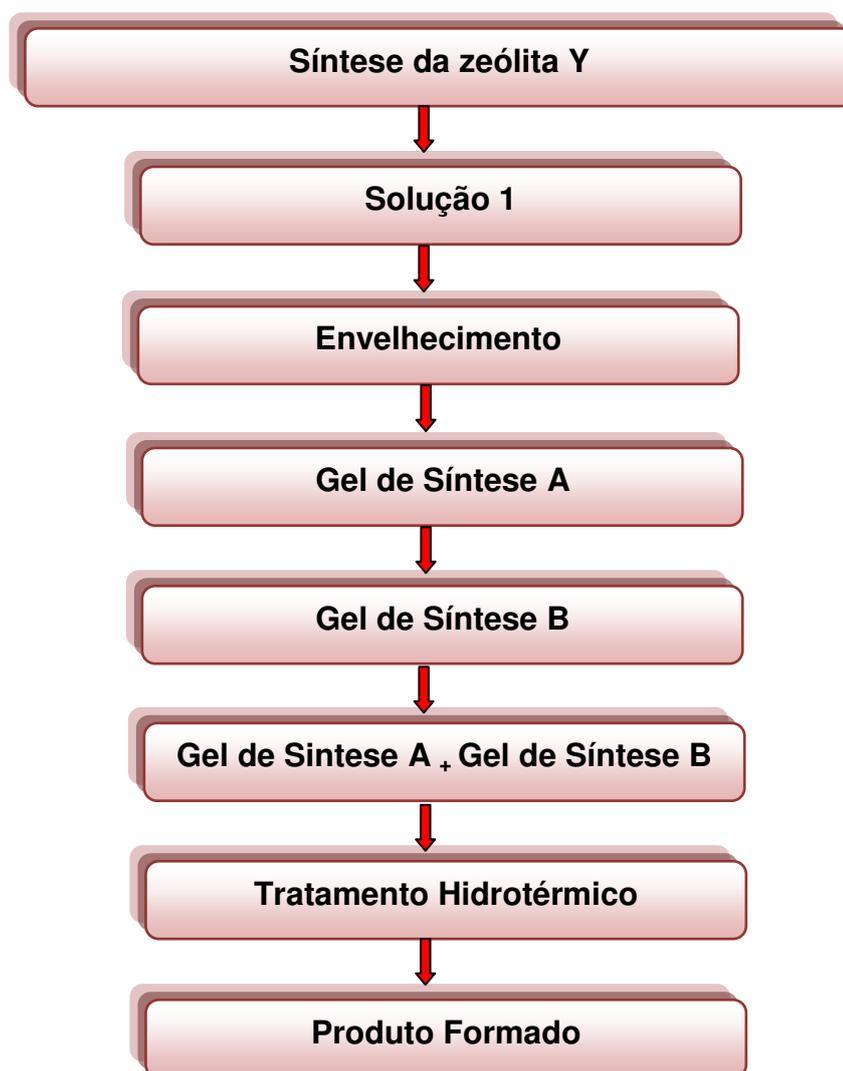
A síntese da zeólita Y foi realizada utilizando-se o método de síntese adotado pela IZA (International Zeolite Association). Inicialmente preparou-se dois géis denominados de gel A e B.
