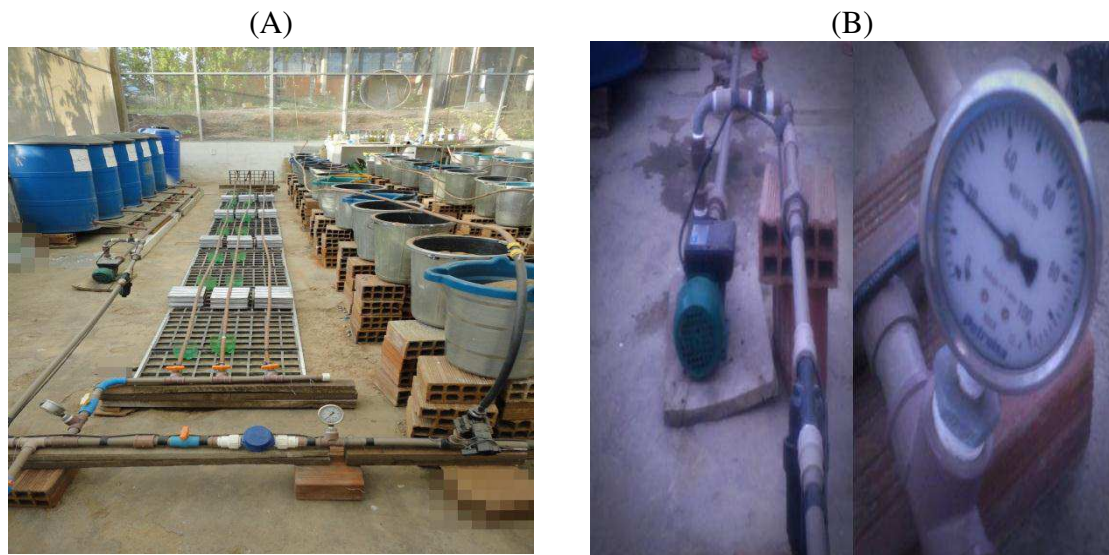
Figura 2– Estrutura para avaliação composta de 3 mangueiras e cinco reservatórios com água salina(A) e conjunto motobomba com filtro e manômetro (B) .
