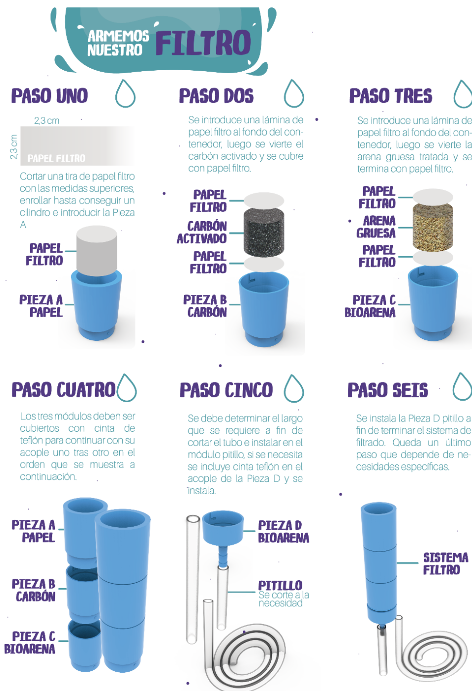
Figura 19 – Passos de montagem do filtro AcuaLab
