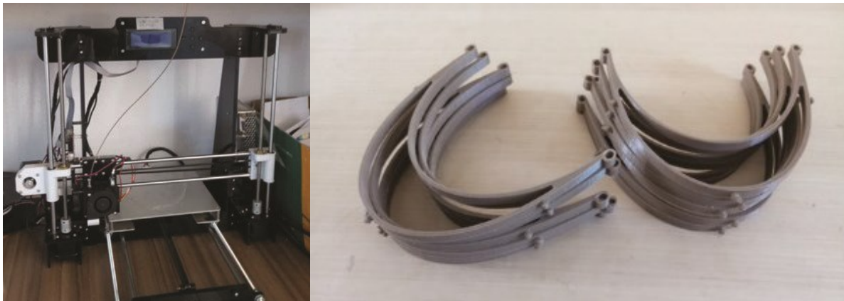
Figura 26 – Impressora 3D utilizada e suporte dos face shields
