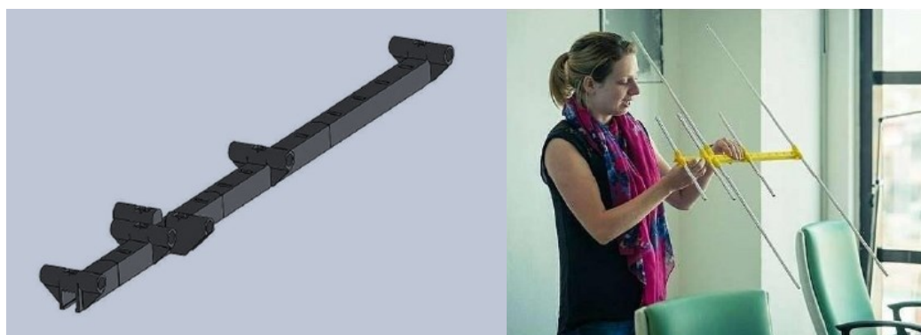
Figura 28 – Peça para Antena Duoband Yagi
