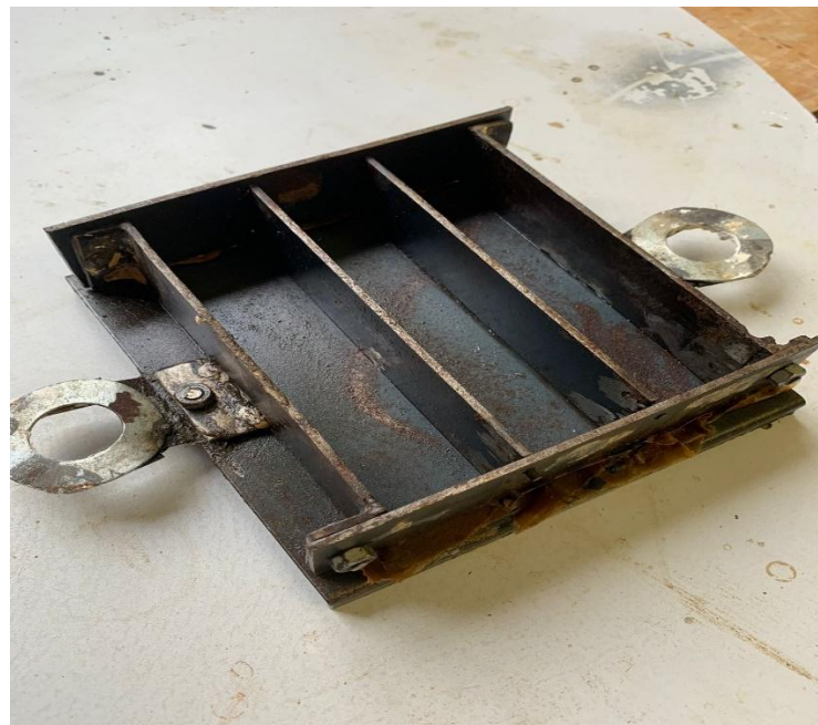
Figura 6 - Formas de ferro para confecção dos corpos de prova
