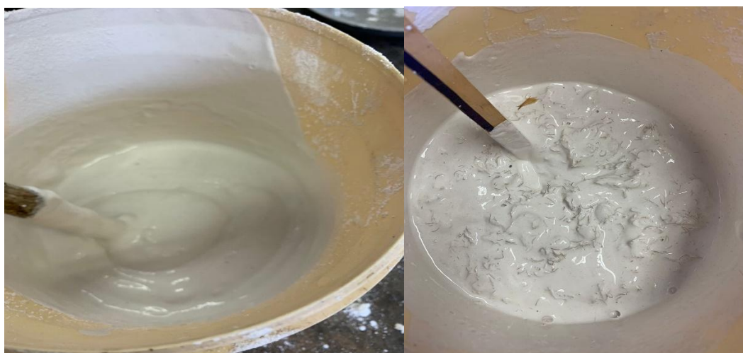
Figura 7 - Imagem à esquerda: Pasta de gesso sem fibra; Imagem à direita Pasta de gesso com adição de fibra
