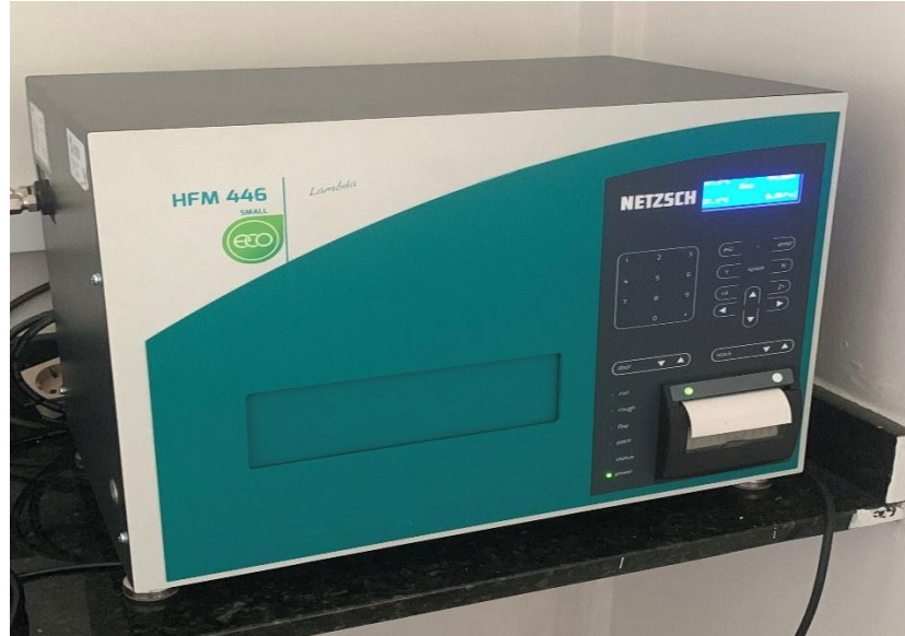
Figura 13 - Equipamento utilizado para determinação da condutividade térmica
