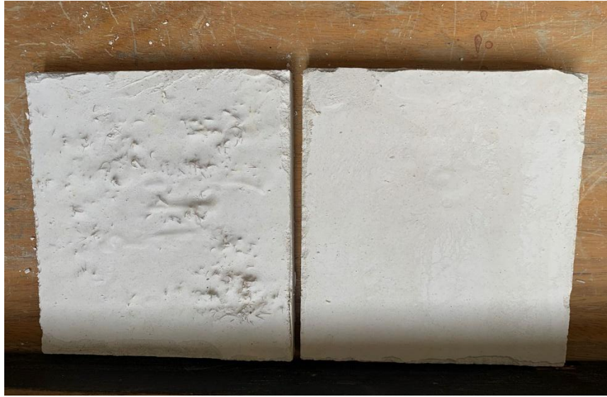
Figura 10 - Imagem à esquerda: placa de gesso com adição de fibra de açai; Imagem á direita: placa de gesso sem adição da fibra de açai
