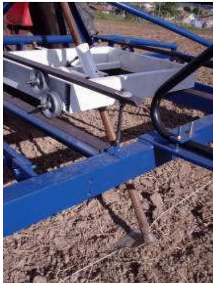
Figura 2. Detalhe do sistema de roldanas com a enxada já acoplada e sendo testada no campo.
