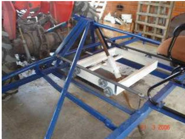
Figura 1. Quadro porta ferramentas, enfatizando o sistema de três pontos e a mão francesa.
