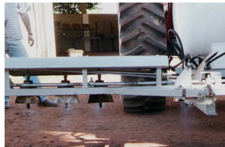
Figura 1. Protótipo da COMPANHIA ULTRAGAZ: Vista geral do equipamento e detalhe dos queimadores.
