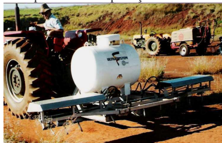
Figura 1. Protótipo da COMPANHIA ULTRAGAZ: Vista geral do equipamento e detalhe dos queimadores.
