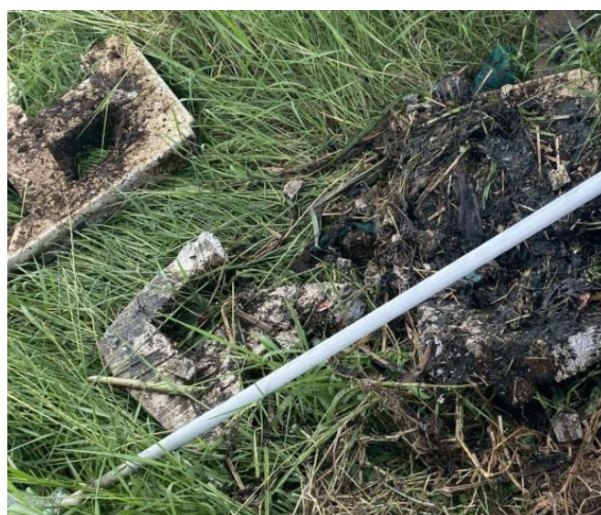
Figura 23 - Exemplo de módulos que romperam após a retirada da lagoa
