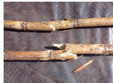
Figura 4. Canas “mastigadas” pelo sistema transportado.
