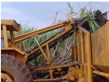
Figura 2. Sistema de deflexão das canas transportadas
