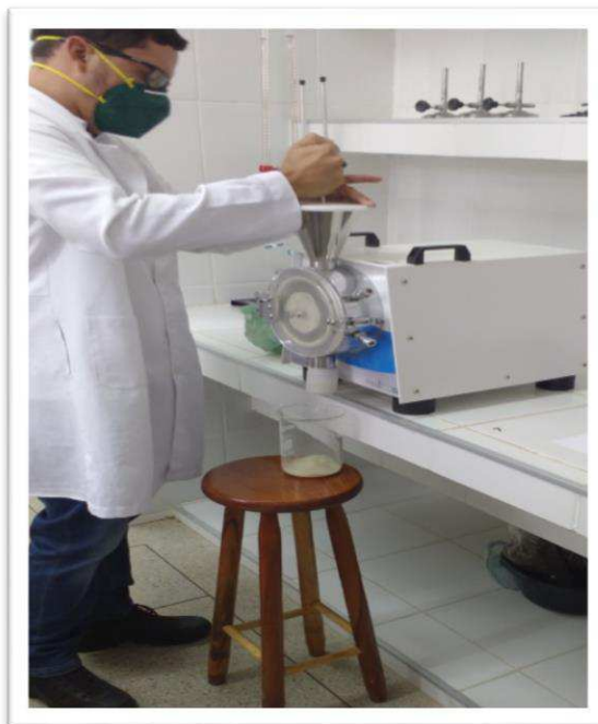
Figura 10 - Cominuição da biomassa para forma de pó por meio do moinho de facas.
