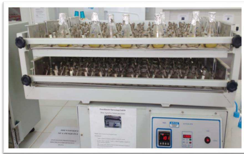
Figura 12 - Frascos erlenmeyer contendo a mistura água/gasolina e biomassa na mesa agitadora, sob agitação a 130 rpm e temperatura constante.
