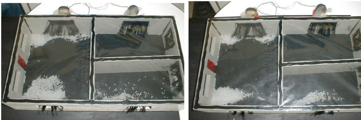
**Figura 4** - Simulação de vento natural perpendicular à parede longitudinal
