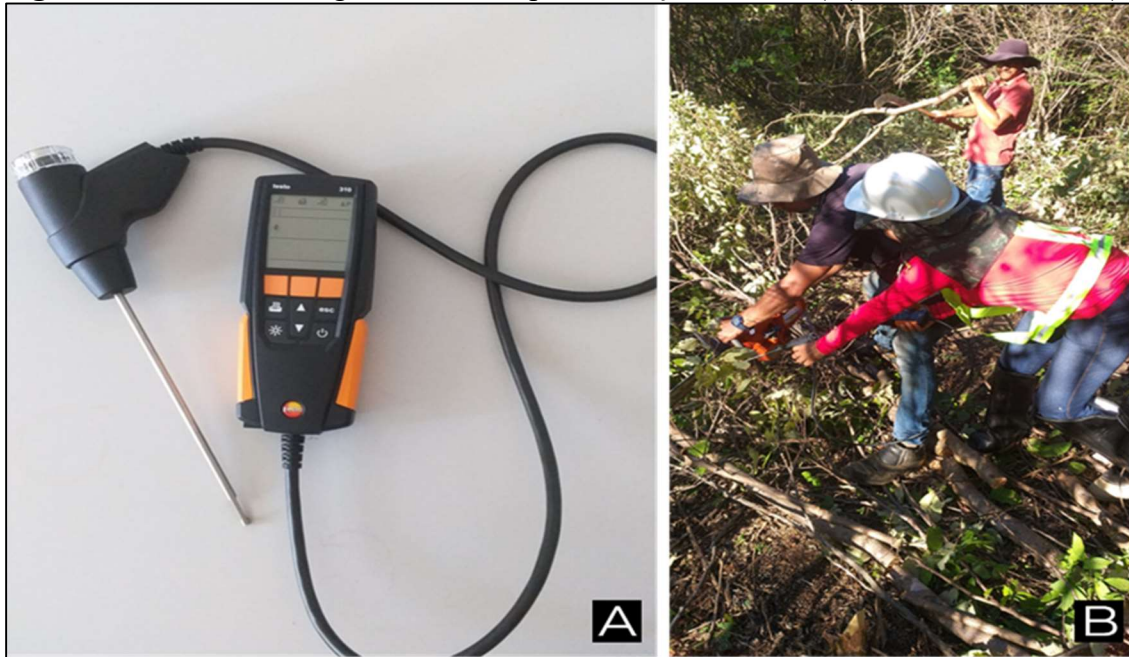
Figura 6 - Analisador de gases utilizado para medição de CO 2 (A) e Coleta de dados (B).
