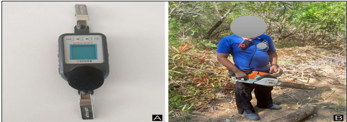
Figura 9 - Dosímetro utilizado para análise de ruído. (A) Dosímetro; (B) Operador utilizando dosímetro.
