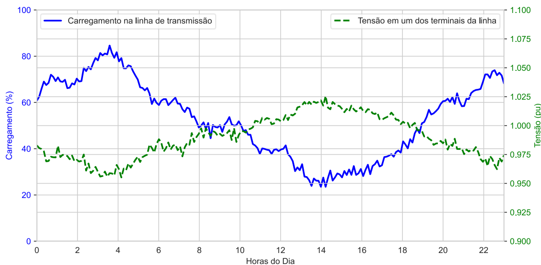
Figura 2.2: Oscilação de fluxo de potência e tensão típica em uma linha de transmissão localizada na região influência de uma central geradora eólica.
