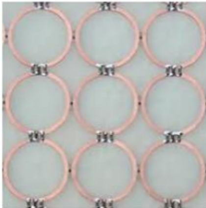
FSS reconfigurável com geometria em forma de anéis de dupla polarização
