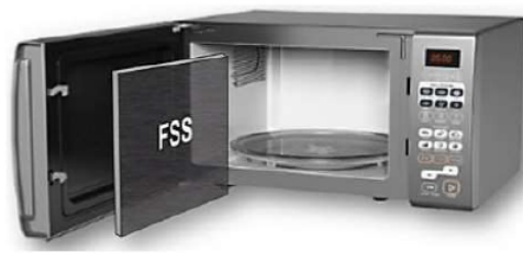
Figura 2.11: FSS utilizada como anteparo na porta do forno de micro-ondas [83]
