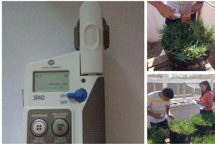
Figura 2.5 - Imagem do clorofilômetro usado nas leituras de clorofila das folhas do capim Tifton 85.
