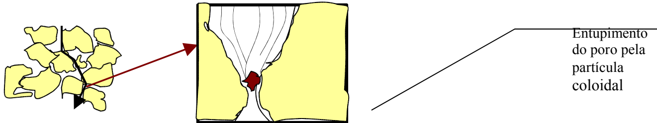
FIGURA 2: Colmatação dos poros com aplicação de efluente rico em matéria orgânica. (Fonte: McGeCHAN, et al (2002), adaptado)
