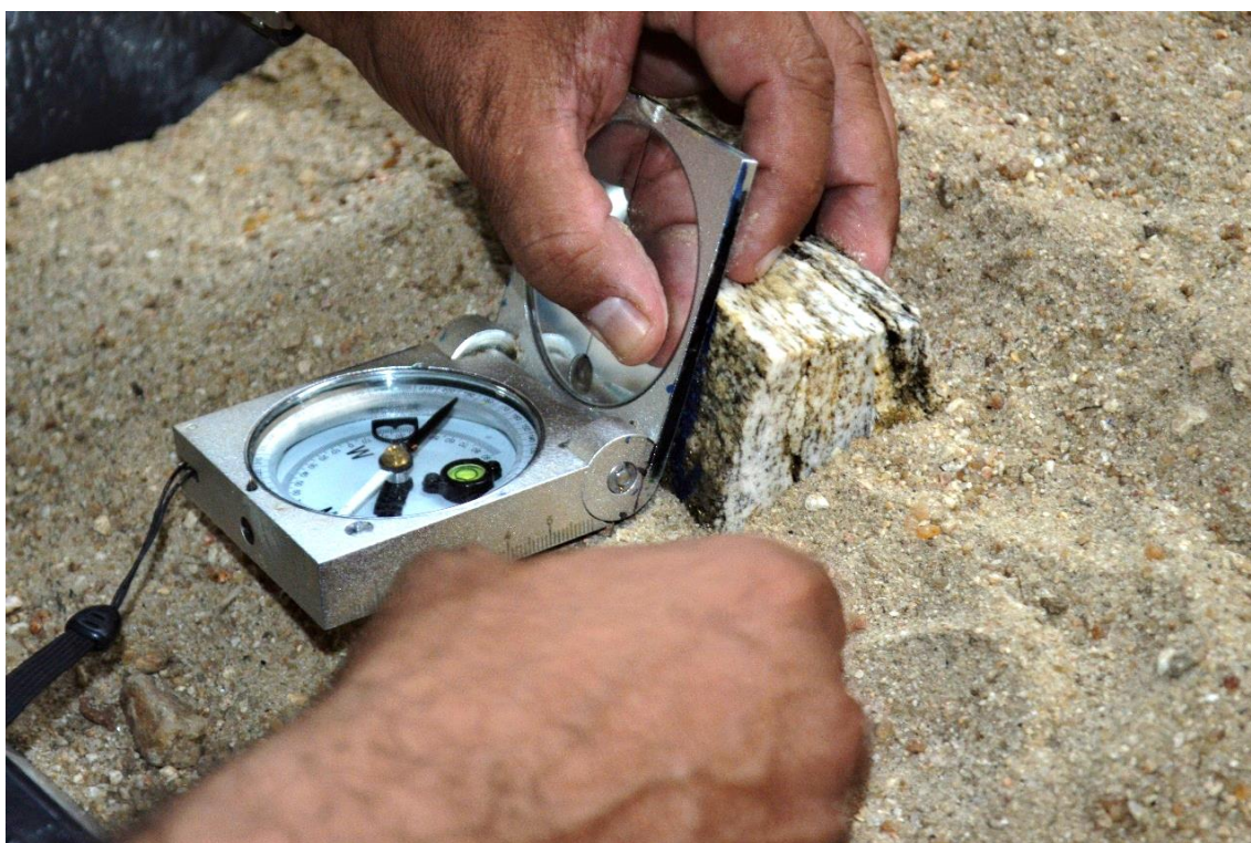
Figura 16 - Orientação da seção de uma amostra na caixa de areia, para reproduzir a orientação em campo. A foto mostra uma seção onde são medidos o mergulho e o seu sentido com bússola tipo clar .
