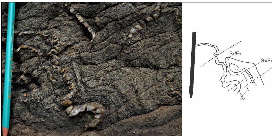
Figura 11 - Padrão de interferência F_1 + F_2 . Observar que o traço axial de dobras F_1 ( S_2 ) são dobrados pela superposição de dobras F_2 . Essas últimas mostram traço axial relativamente reto ( S_3 ).
