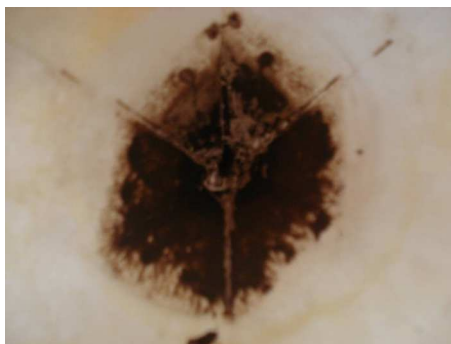
Figura 4.10 Precipitado gerado durante oxidação do óleo mineral a 110°C
