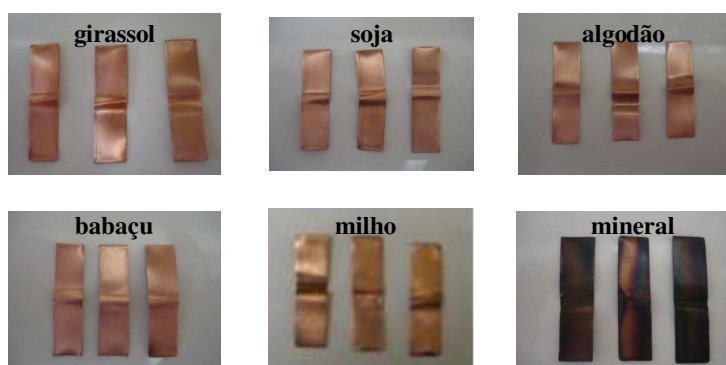
Figura 4.4 Fitas de cobre após ensaio de enxofre
