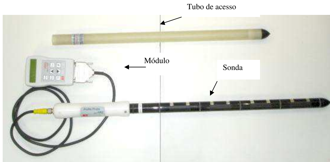
Figura 1 - Sonda de perfil (PR2/4) da Delta-T Devices Ltd., com as principais peças.
